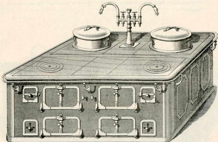
Composé de : 2 Façades et 2 côtés à panneaux en fonte ou en tôle, 2 Foyers mixtes au bois et au charbon, 2 grands Fours à rôtir, 2 Étuves, 2 Fours chauffe-assiettes sous les marmites, 2 Marmites en cuivre ou en fonte polie avec panaches et couvercles fer battu étamé ou cuivre poli, 1 Robinet à colonnes à double distribution alimentant les marmites, 1 Barre en fer ou en cuivre régnant autour du fourneau.
